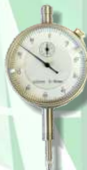
MT 3102 zakres 0-10 mm dokładność 0,01mm
