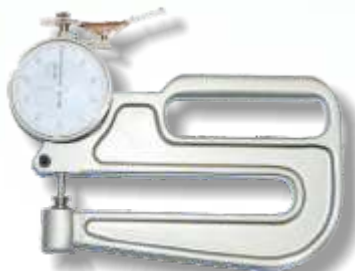
MT 4103 zakres 0-10 mm dokładność 0,01mm
